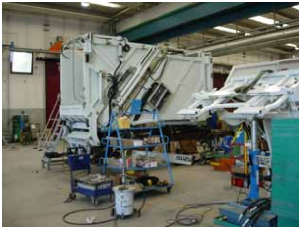
OMB nadgradnja sa visokim stepenom sabijanja (1:7)
