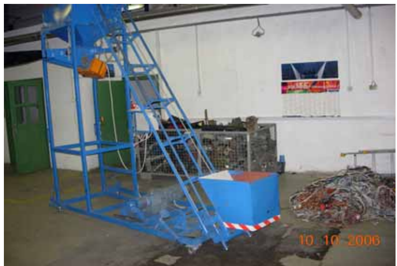
Deo linija u kojima se melju i razdvajaju pojedine komponente električnih uređaja
