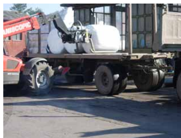
Detalji iz postrojenja – posle mlevenja, otpad se balira i obmotava sa armaturnom mrežom i na kraju sa streč folijom – Problem je šta raditi sada sa formiranim balama
