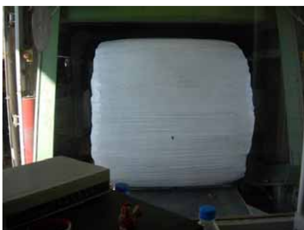
Detalji iz postrojenja – posle mlevenja, otpad se balira i obmotava sa armaturnom mrežom i na kraju sa streč folijom – Problem je šta raditi sada sa formiranim balama
