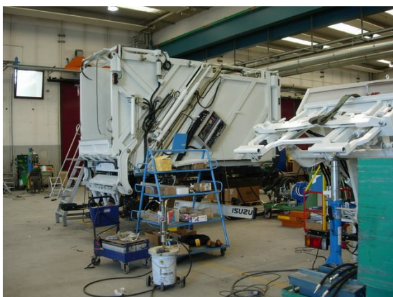
OMB nadgradnja sa visokim stepenom sabijanja (1:7)
