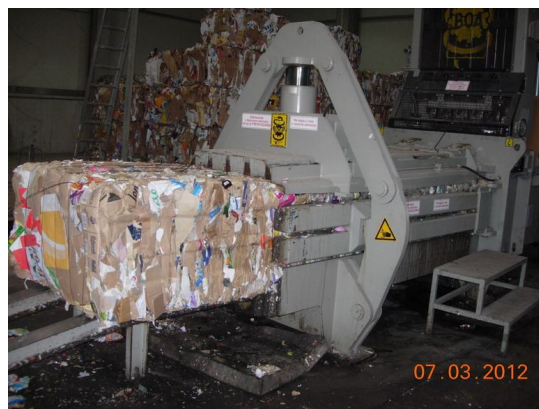
Ulazna tabla i automatska presa u postrojenju za sekundarnu selekciju recikabilnih materijala
