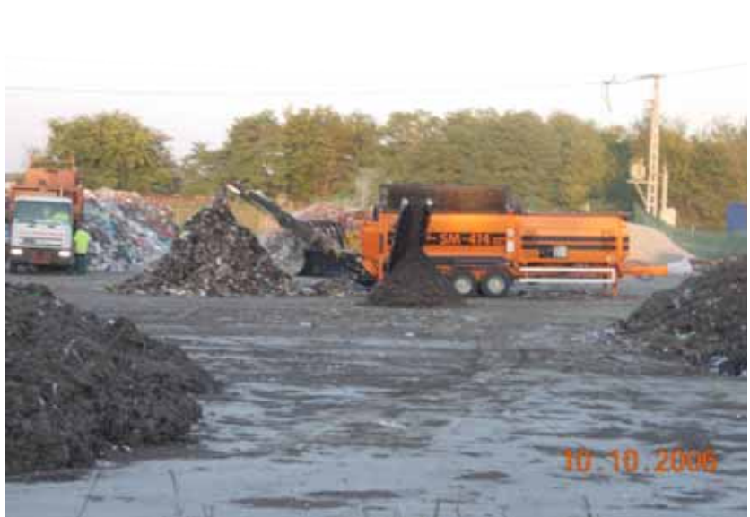
Levo – direktor Čistoće iz Kragujevca Desno - predtretman na 4 ha otvorene površine– manuelna separacija, razdvajanje i mlevenje frakcija radi smanjenja organskih komponenti pre odlaganja
